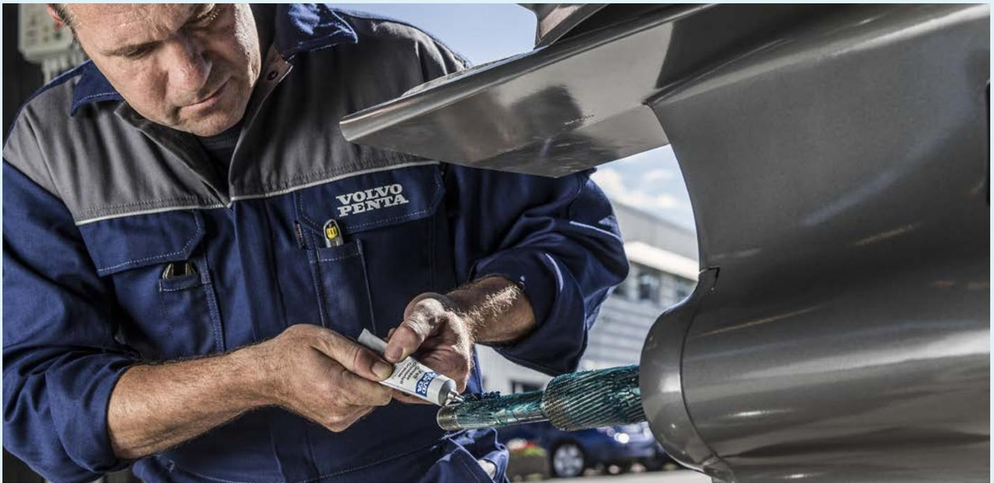
**Besoins de lubrification.** l'arbre d'hélice doit être nettoyé et relubrifié au moins une fois par an, ainsi que lors du remplacement de l'hélice. Une lubrification régulière évitera tout grippage de l'hélice sur son arbre. Se reporter au manuel d'utilisation pour connaître les périodicités de lubrification recommandées.
